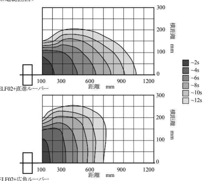
※最大風量時、±1000V から ±100V までの除電時間 (弊社測定条件による)
